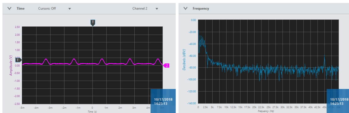
Рисунок 5: Представление Sync-импульса во временной и частотной областях на выходе модуля TUNEABLE LPF
