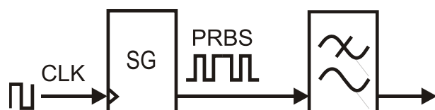
Рисунок 8: Блок-схема генерирования аналогового шума на основе псевдослучайной битовой последовательности
